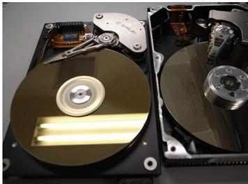
Support de stockage mécanique de forme cylindrique formé de plaques métalliques rigides enduites d'un revêtement magnétique. La capacité de stockage (soit la quantité d'information pouvant être stockée) est en giga-octets (Go), soit un milliard d'octets.
